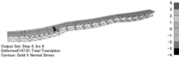
図1 トラス橋のリダンダンシー解析結果の一例
