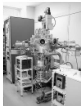
対向ターゲット式RFマグネトロンスパッタリング装置
