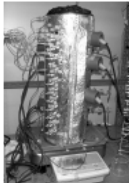
湿地土壌における温室効果ガスの移動特性の評価を行うカラム実験装置
