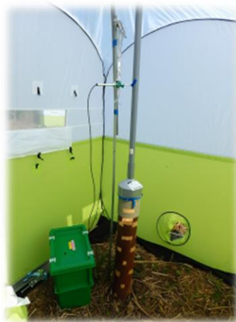
観測井戸のガス流量調査
