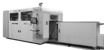
高速砂型造形 3D プリンター (1800×1000×750mm) 写真：(株)シーメット 提供
