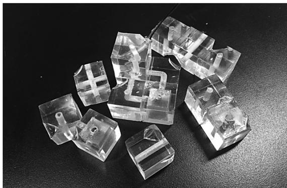
化学実験用流体ブロックの製作例
