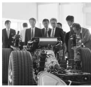
直噴ターボエンジンを搭載したレヴォーグのパワートレイン
