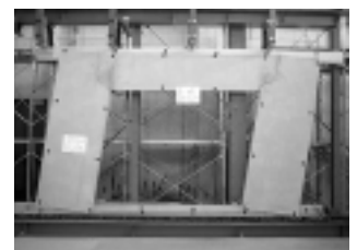
写真2 モルタル塗り通気工法外壁
