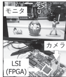
実時間SIFT特徴点検出LSIの動作検証
