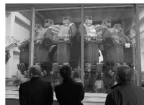
解体後搬出された 磁場コイル
