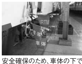
安全確保のため、車体の下で作業中は旗を掲出している
