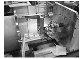
摩擦試験装置。大気中、真空中の摩擦特性を調べることができます。
